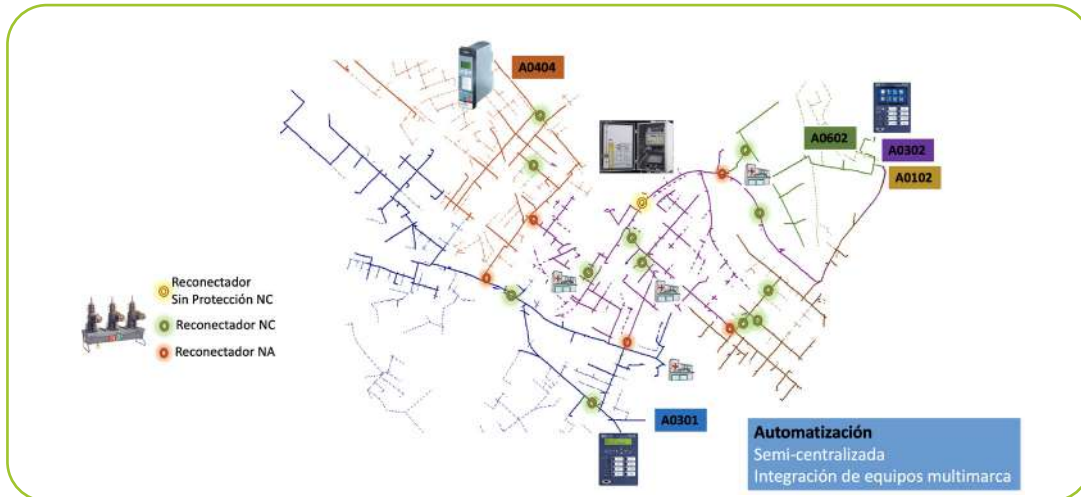
Figura Nro. 28: Topología alimentador La Georgina
